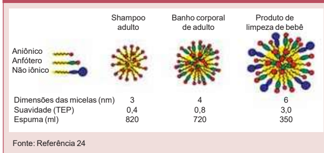
Figura 1. Dimensões, propriedades de formação de espuma e suavidade das micelas de três diferentes sistemas tensoativos
