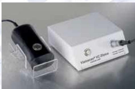
O **Visioscan VC 20plus** é uma câmera de alta resolução, com fonte de luz UV e com autofoco, para iluminação homogênea da superfície da pele.
