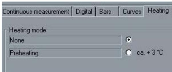
Selecionar se o pré-aquecimento deve ser acionado antes de cada medição. Destaque-se que, o aquecimento dos sensores não é possível quando a sonda Tewameter estiver desplugada da unidade básico MPA e estiver sendo usada com o dispositivo portátil operado por bateria.
