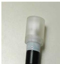
Há necessidade de vedar o cabeçote da sonda (câmara aberta) com a tampa de checagem de calibração.
